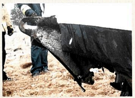
Abgerissene Abschleppöse nach einem Bergeversuch. Diese Ösen sind von ihrer Auslegung nur zum Ziehen des Fahrzeugs auf befestigtem Untergrund geeignet.
