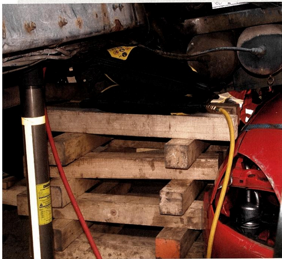
So sieht ein richtig gesetzter Kreuzholzstapel für Hebekissen aus: Enden der Hölzer stehen mindestens 5 cm über, obere Plattform als Auflage der Hebekissen. Zusätzlich wird ein Unterbau mit Hilfe einer Rettungsstütze erstellt. So lässt sich die Last sicher anheben.
