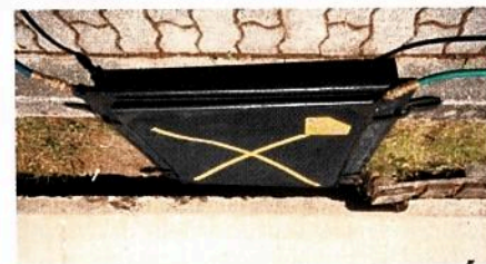
Der Fahrbahnteiler wird einseitig angeho-ben. Drehpunkt ist das vom Patienten entfernte Ende des Betonlements. Während
