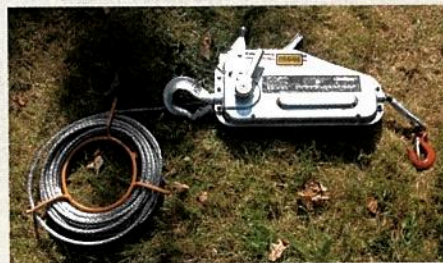
Mehrzweckzug, auch umgangssprachlich Greifzug (nach dem Hersteller) genannt, Bauform TU8 mit 8 kN Zugkraft. Wird er fertig eingefädelt gelagert, spart das Zeit und vermeidet Fehler unter Stress.
