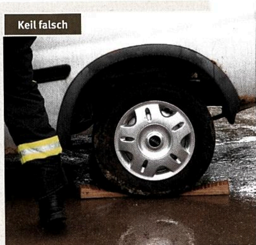
Falsch: flacher, wirkungsloser Keil unter dem Rad. Pkw rollt darüber hinweg.
