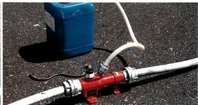
rechts: Zumischung des Firesorb-Gels am Z2R-Zumischer beim Test 3
