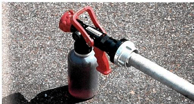
links: Hohlstrahlrohr mit F-500-Behälter beim Test 2
