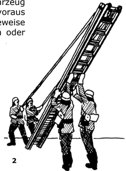
Der Leiterfuß wird im je nach Einstiegshöhe erforderlichen Abstand vor dem Objekt unterhalb der Einstiegsöffnung abgelegt. Ein Trupp löst die Halteriemen der Stützstangen, nimmt die Stützstangen hoch und sichert den Leiterfuß. Während der eine Trupp die Leiter aufrichtet, hilft der andere Trupp dabei durch Ziehen an den Stützstangen. Die Leiter wird senkrecht gestellt, die Stützstangen stehen seitlich zum Objekt hin.
