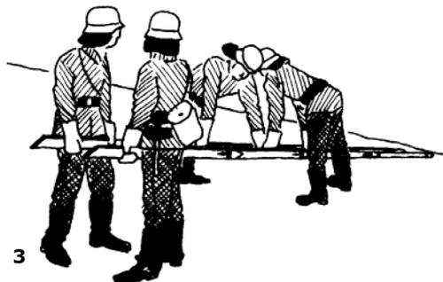
3. Der jetzt am Kopfende der unteren Leiterteile befindliche Trupp steckt die oberen Leiterteile mit den unteren Leiterteilen zusammen. (Auf Verriegelung durch die Federsperrbolzen achten!). Sollten beispielsweise nur 3 Leiterteile gebraucht werden, so werden zunächst alle 4 Teile zusammengesteckt und dann ein Leiterteil abgenommen.
