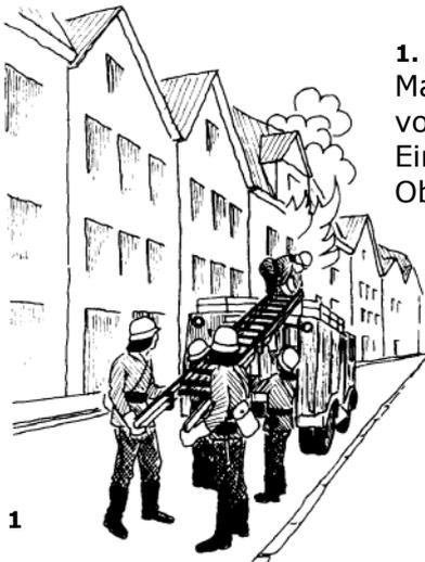
1. Die beiden befohlenen Trupps nehmen mit Unterstützung des Maschinisten die Steckleiter vom Fahrzeug und tragen sie -Leiterfuß voraus- zum Objekt. Es werden grundsätzlich alle Steckleiterteile zum Einsatzobjekt getragen. Dort legen sie die Leiter einen Schritt vor dem Objekt unterhalb der Einstiegsöffnung ab.
